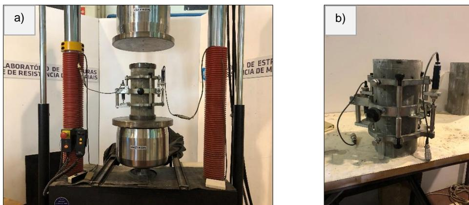
Figura 3.22 – a) Prensa INSTRON b) Estrutura utilizada com transdutores de deslocamento
