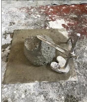
Figura 3.16- Ensaio de abaixamento segundo NP EN 1 2350-2
