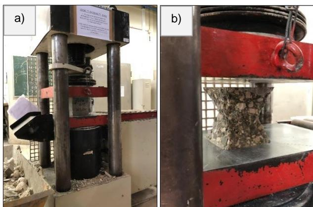
Figura 3.20 – a) Prensa TONI PACT 3000 b) Provede após ensaio de compressão
