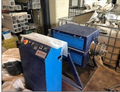
Figura 3.6 - Forno elétrico rotativo ThermoLab Scientific Equipments
