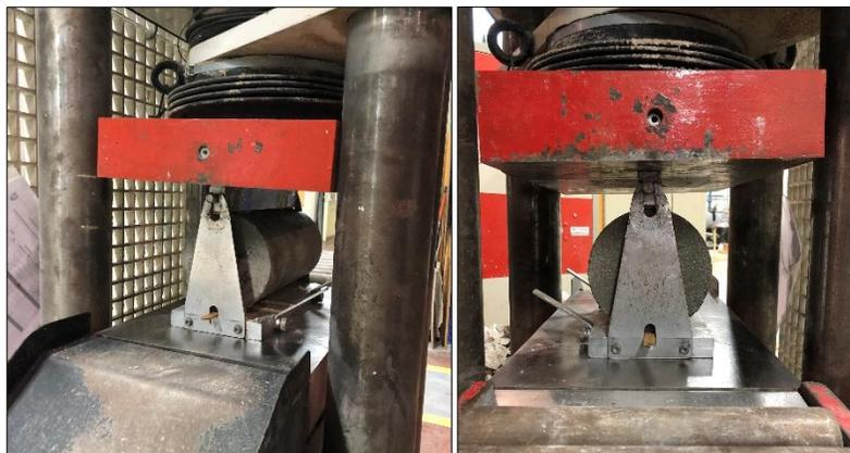
Figura 3.21 – Ensaio à tração por compressão diametral
