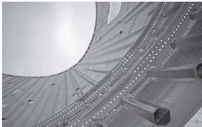
Figura 2.1: Fuselagem do tipo *semimonocoque* [1].
