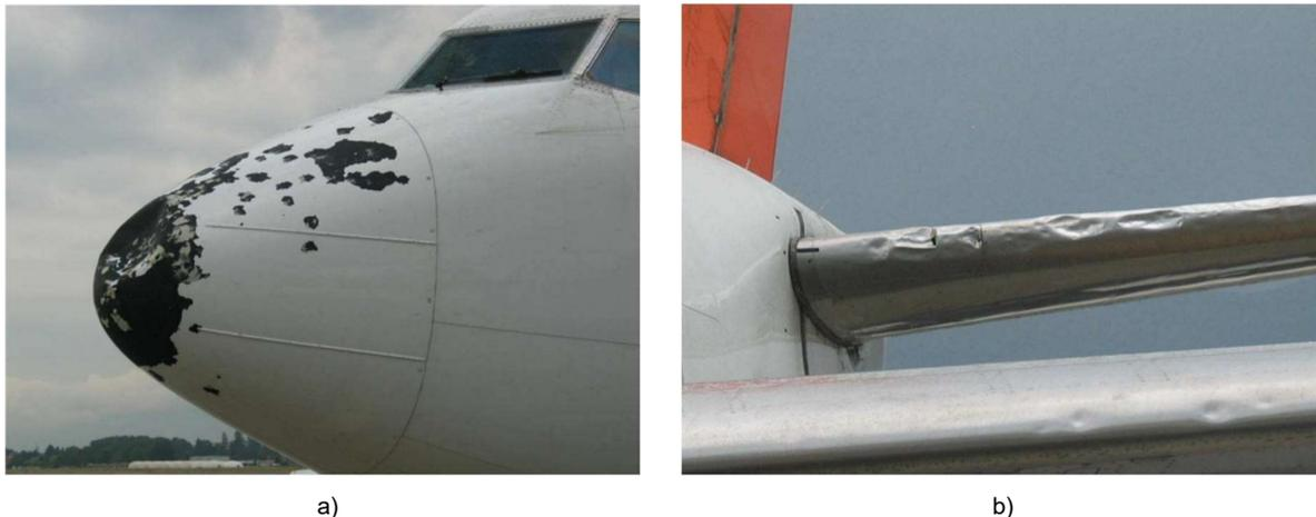
Figura 1.1: Dano causado por uma tempestade de gelo num Boeing 737 no a) nariz e b) asa/estabilizador horizontal [3].
