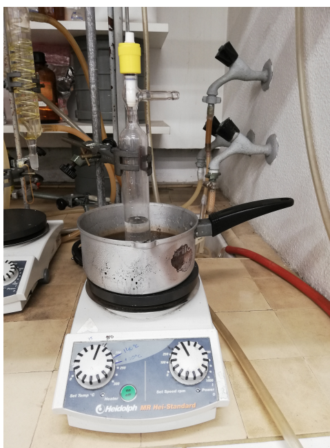
Figura 2.3: Montagem de um schlenk fechado equipado com uma torneira J. Young numa placa de aquecimento com agitação magnética
