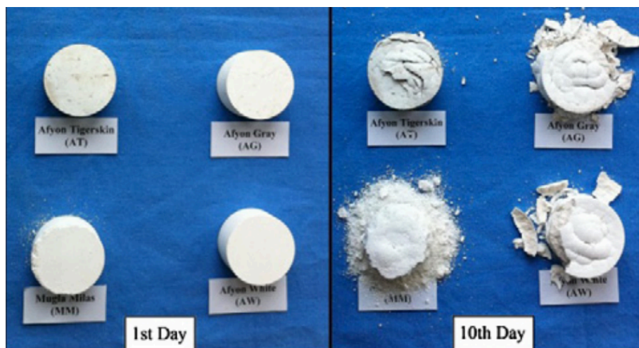
Figura 2.12 – Evolução das amostras de mármore após exposição a 800°C (Adaptado de Ozguven and Ozcelik [10]).
