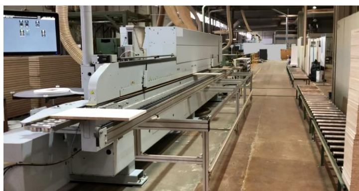
Figura 4.8 - Máquina orladora do posto O3
