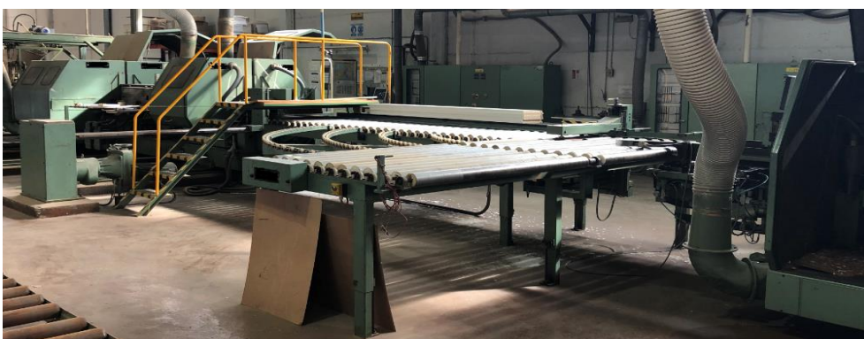
Figura 4.7 - Transição automática de peças de O1 para O2
