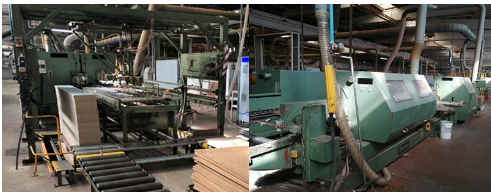
Figura 4.6 - Alimentação de peças na máquina O1 (à esquerda) e zona de saída de peças na máquina O2 (à direita)
