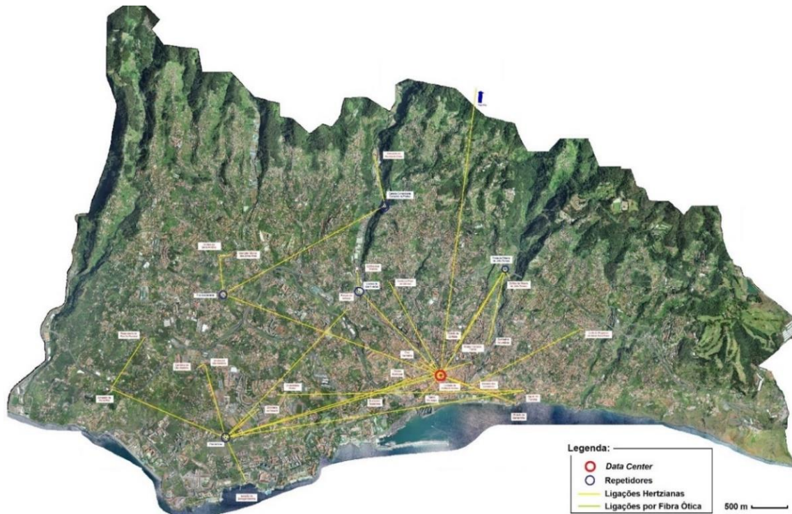
Figura 4.2 – Mapeamento da rede de comunicações da CMF [45].
