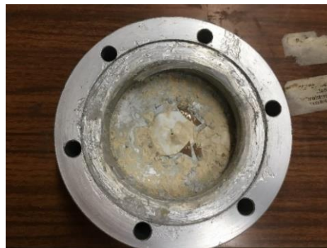
Figura 4.4 - Saída lateral da base obstruída por finos
