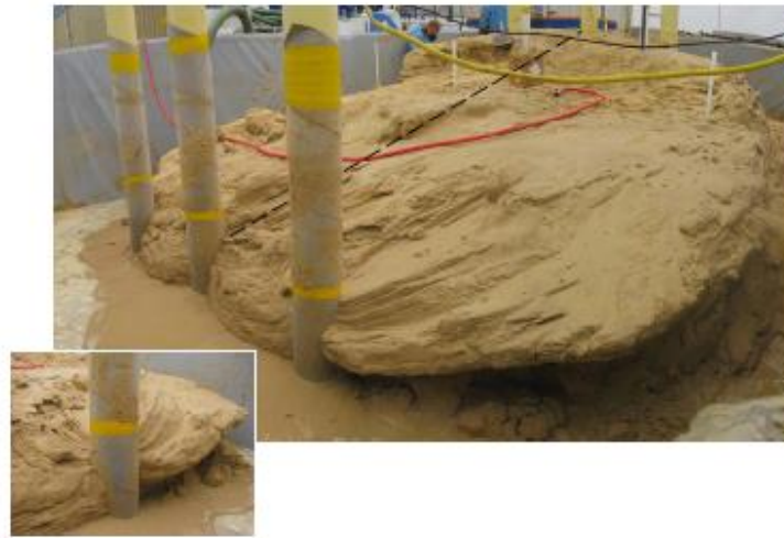
Figura 2.7 - Exposição do corpo de areia biocimentado, após lavagem de partículas desagregadas (Van Paassen et al., 2009)
