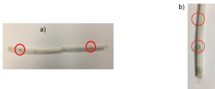
Figura 4.8 - Presença de precipitado no interior dos tubos injetores a) provete B2ct e b) provete B3ct
