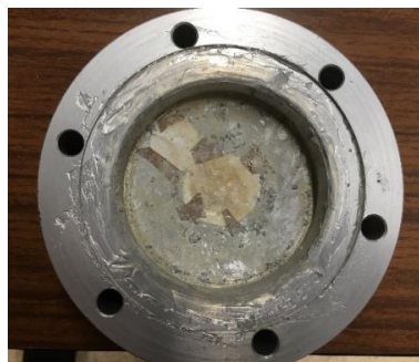
Figura 4.7 - Saída central sem obstrução de finos após tratamento
