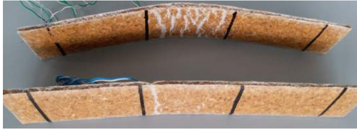
Figura 40: Provetes C2/SG1 e C2/SG2, após o último ensaio de fluência a 70°C.
