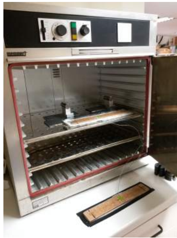
Figura 34: Obtenção dos valores para calibração, no início de um ensaio de fluência.
