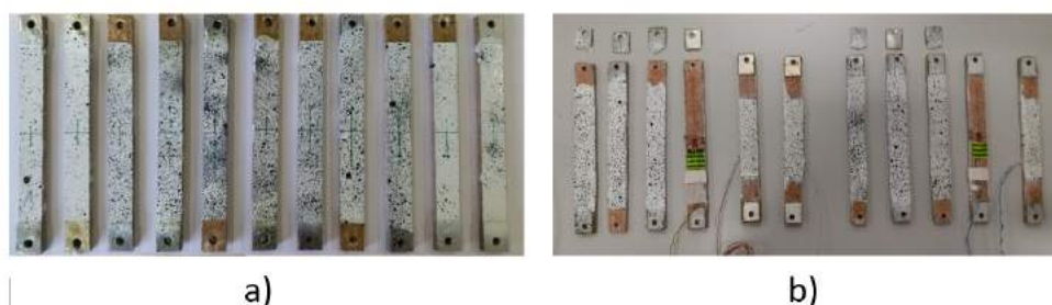
Figura 35: Provetes de tração após os ensaios destrutivos: a) lotes TA, TB e TC e b) lotes TD e TE.
