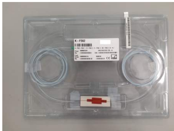
Figura 16: Sensor de Bragg K-FS62.
