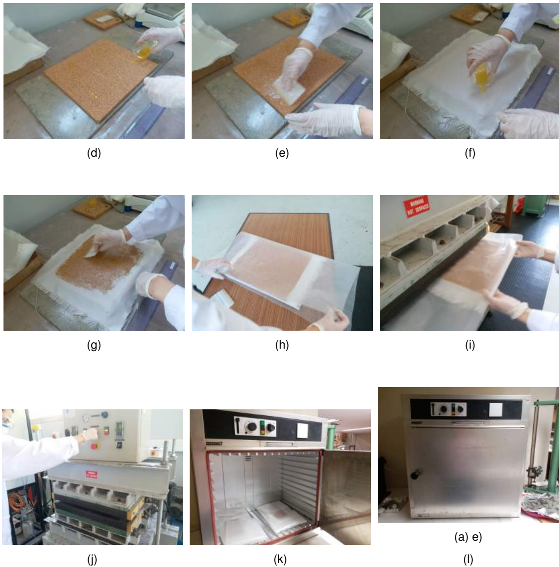
Figura 14: Sequência do método de produção dos provetes.
