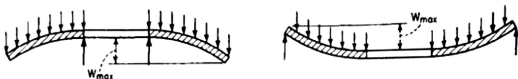
Figura 8 - Esquema de uma laje simplesmente apoiada pelo intradorso (esq.) e extradorso (dir.) (retirado de Timoshenko e Woinowsky-Krieger 1959).
