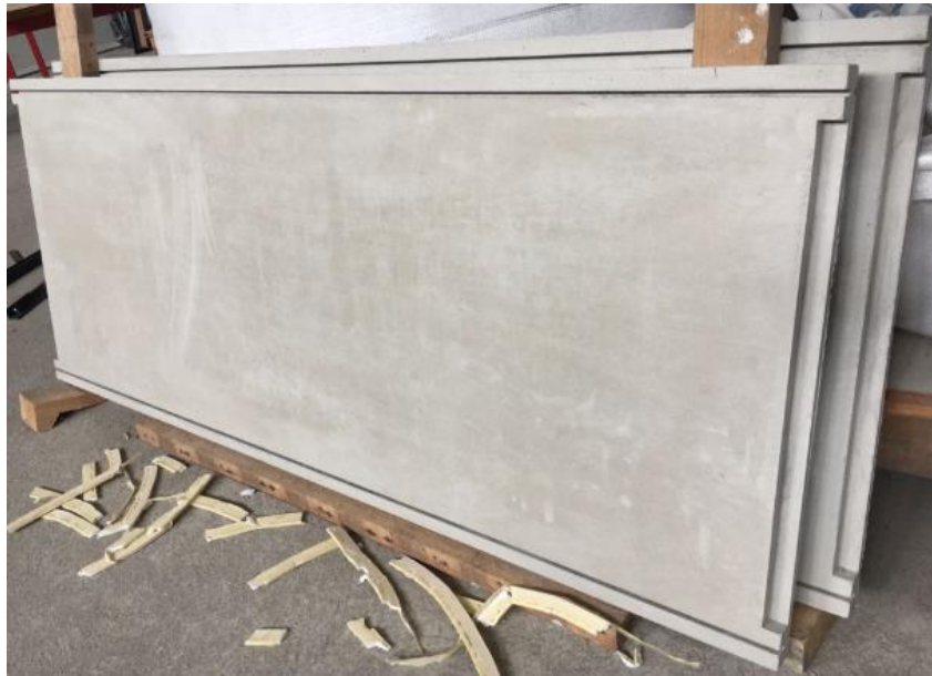
Figura 4.8 – Placas de betão após descofragem
