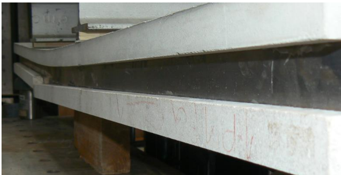
Figura 5.7 – Flexão da placa de betão
