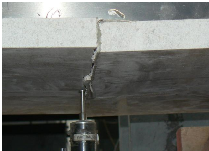
Figura 5.6 – Fraturação da pedra por corte ao longo da secção de colagem
