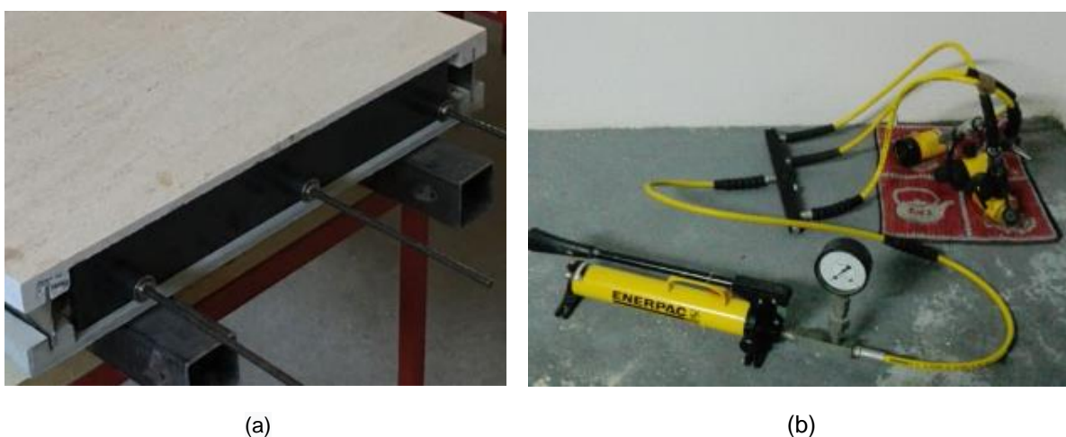
Figura 3.6 – (a) Fios de pré-esforço \Phi 6 e placa de ancoragem; (b) Macaco hidráulico
