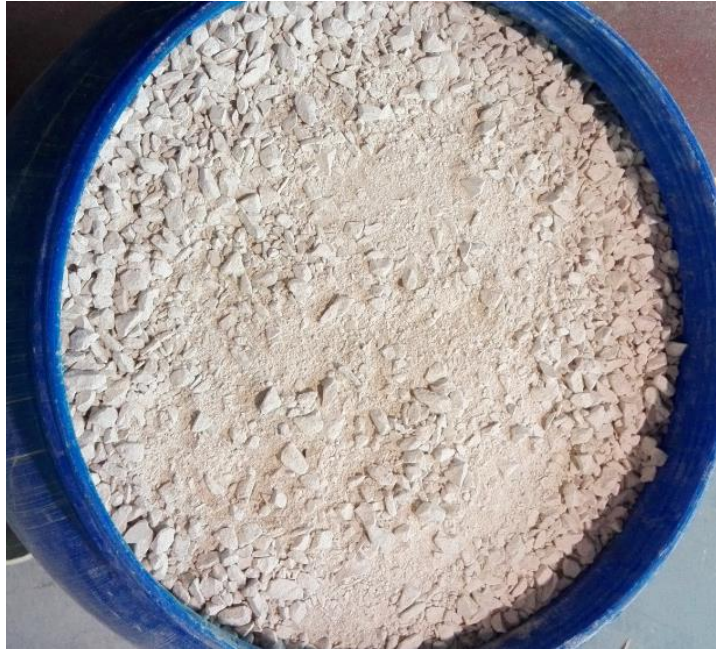
Figura 4.2 – Mistura resultante da primeira britagem
