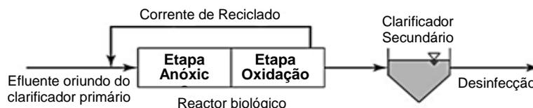
Figura 2.3: Configuração de um reactor biológico para remoção do nitrogénio (adaptado de Mihelcic & Zimmerman, 2010).
