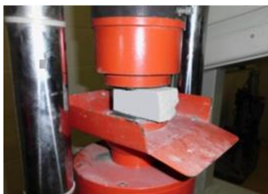
Figura 3.14 - Ensaio à compressão de um provete normalizado de argamassa.
