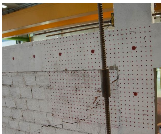
Figura 4.8 - Rotura da parede de alvenaria do pórtico 1 a) imagem geral, b) pormenor do canto inferior esquerdo e c) pormenor do canto superior direito (adaptado de Robust Brick (2016)).
