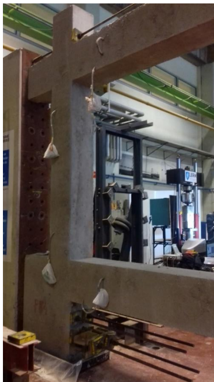
Figura 3.6 - Ligação à parede de reação através de barras Dywidag, duas na parte superior e quatro na parte inferior do pórtico.
