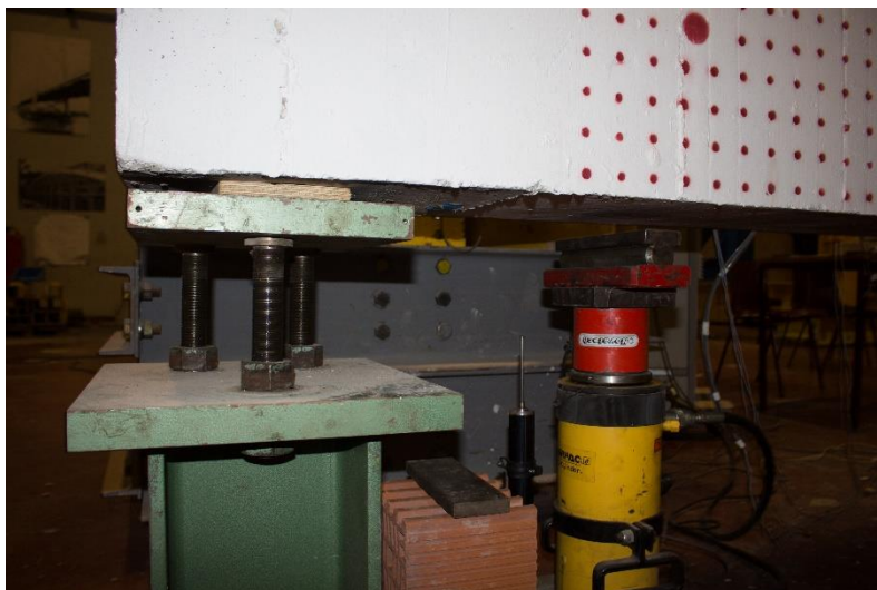
Figura 3.5 - Apoio na base da viga (à esquerda) e macaco hidráulico (à direita) no alinhamento do pilar.
