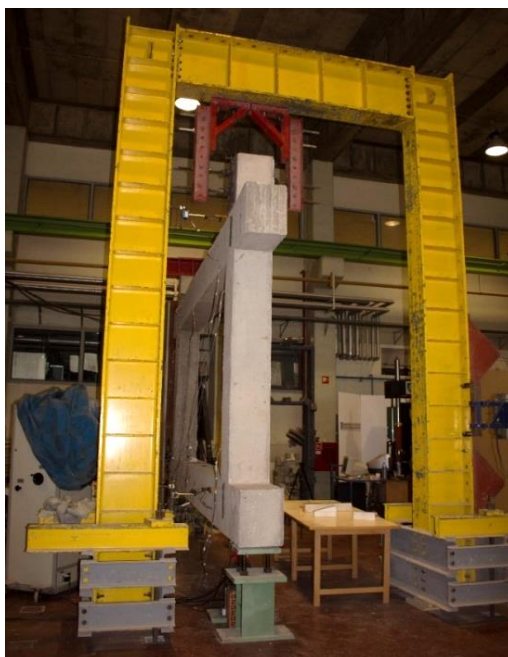
Figura 3.7 -Pórtico metálico (a amarelo) para impedir deslocamentos perpendiculares ao plano do pórtico.
