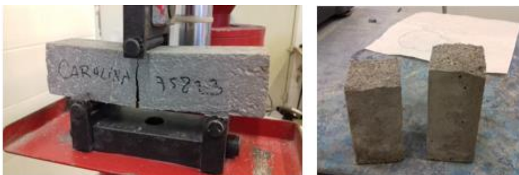
Figura 3.13 - Ensaio à flexão de um provete normalizado de argamassa.
