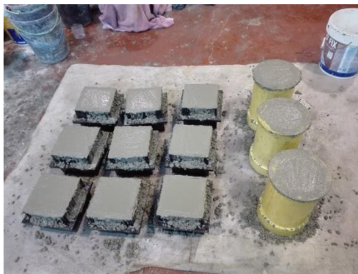
Figura 3.7 - Moldes de betão após enchimento, vibração e alisamento
