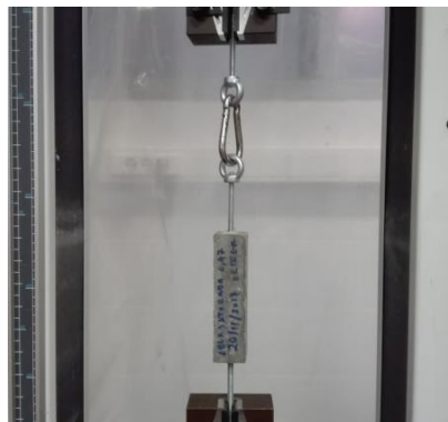
Figura 3.14 - Provete prismático de Leca preparado para a realização do ensaio de tracção axial
