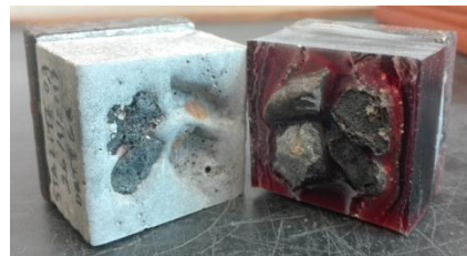
Figura 4.42 - Superfície de fractura atravessando o agregado e a ITZ. Stalite pré-saturada com argamassa de a/c de 0,7
