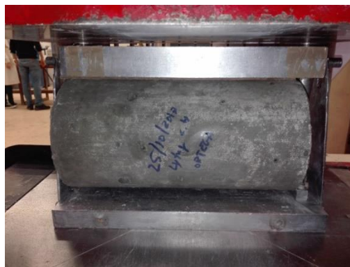
Figura 3.13 - Provete de betão com agregado leve Lytag antes do ensaio à tracção por compressão diametral
