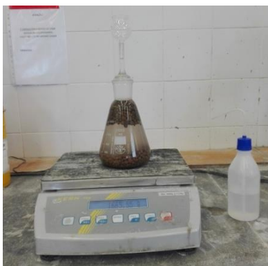
Figura 3.4 - Ensaio de medição da massa volúmica seca e da absorção de água do agregado leve Leca
