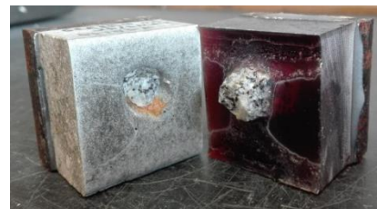
Figura 4.44 - Superfície de fractura atravessando a ITZ. Brita granítica com argamassa de a/c de 0,7
