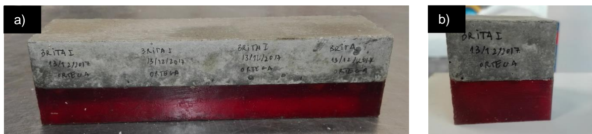
Figura 3.10 - Provede constituído por agregados de brita calcária embebidos em resina e argamassa a)antes do corte; b)depois do corte
