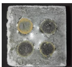
Figura 4.34 - Superfície de fractura de provete através dos agregados de Leca pré-saturada
