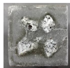
Figura 4.39 - Superfície de fractura de provete através dos agregados de Brita granítica
