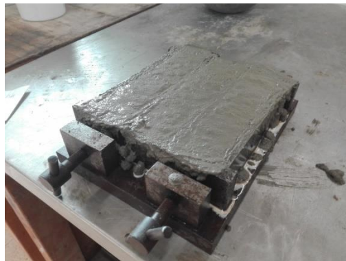
Figura 3.8 - Moldes de provetes prismáticos após enchimento, compactação e alisamento
