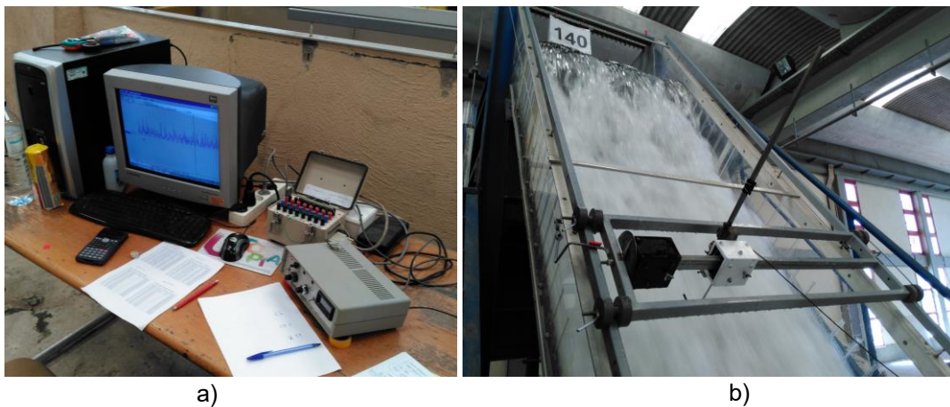
Figura 3.7 – Equipamentos usados para medição da concentração de ar: a) aparelhagem utilizada para a aquisição digital da concentração de ar; b) sonda de ar em funcionamento.
