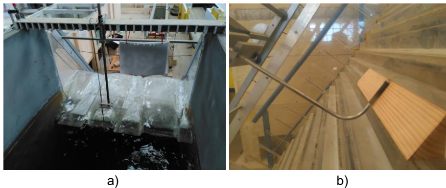
Figura 3.9 – Posição da sonda de ar para: a) calibração prévia com soleira descarregadora do tipo PKW; b) nivelamento das curvas de polarização em computador.
