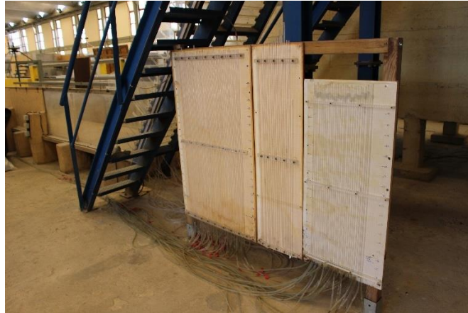
Figura 3.12 – Quadros manométricos da instalação experimental.
