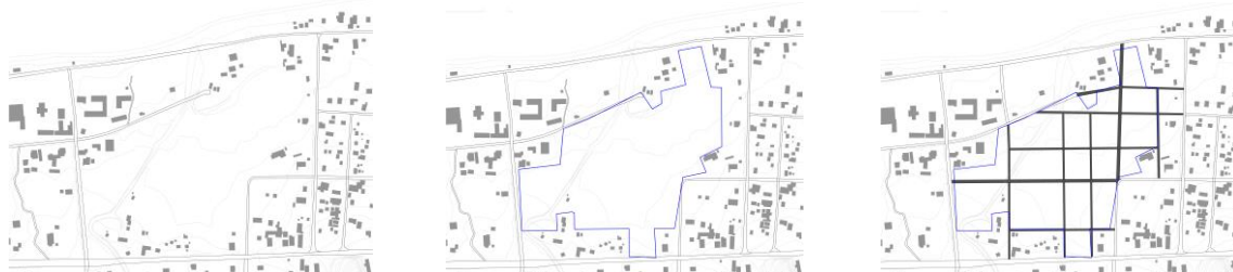
Figura 4.3 – Abordagem ao Lote 3 através da extensão das vias principais e criação de vias secundárias perpendiculares
