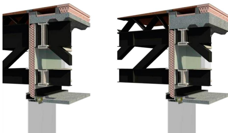
FIGURA 3.4 - EFEITO DA ALTERAÇÃO DA ALTURA DE UMA VIGA - ADAPTADO DE (KENSEK & NOBLE, 2014)
