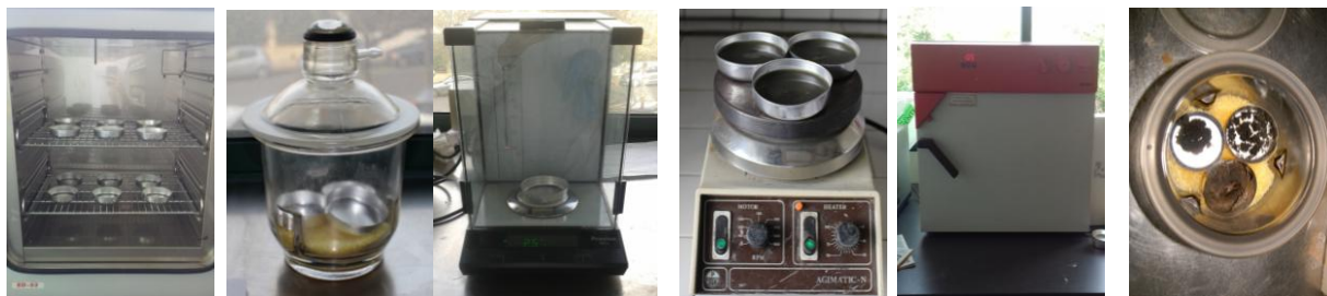
Figura 18 - Etapas do procedimento de análise de TS das lamas no LabAmbi
