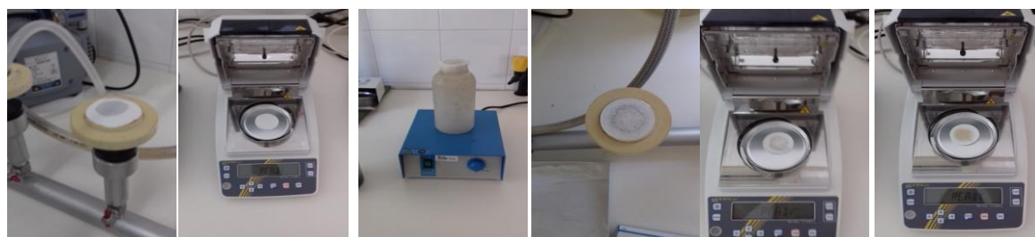
Figura 20 - Etapas do procedimento de análise de teor de sólido suspensos totais das escorrências no Laboratório da Malveira
