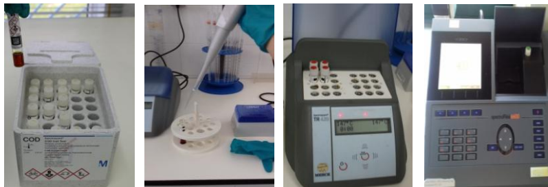
Figura 21 - Etapas do procedimento de análise de carência química de oxigénio das escorrências no Laboratório da Malveira e no LabAmb
