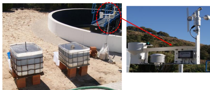
Figura 14 - Localização e pormenor da estação meteorológica portátil WS-GP1.
