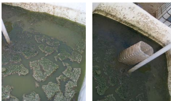
Figura 29 - Camada de água acumulada no interior do leito de secagem piloto, no 35.º dia do 2.º ciclo
