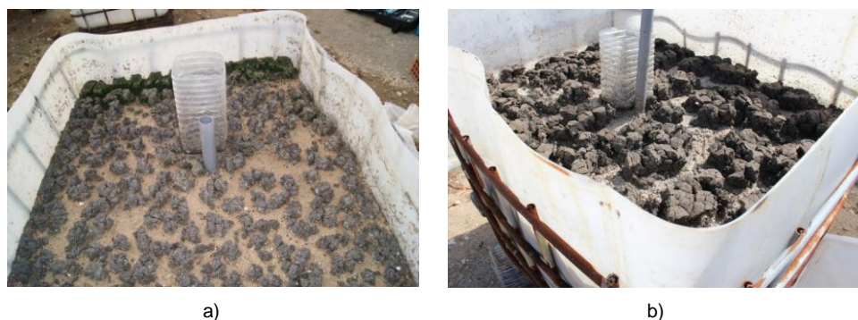
Figura 33 - Torrões formados pela fissuração e retração horizontal da camada de lamas. a) 1.º ciclo; b) 3.º ciclo
