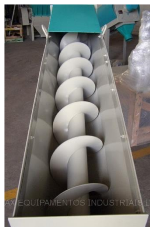
Figura 3 - Transportador semelhante ao encontrado junto aos secadores de rolo [2].
