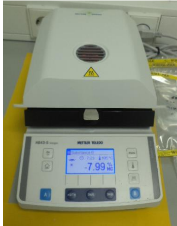
Figura 19 - Medidor de humidade do laboratório do processo.
