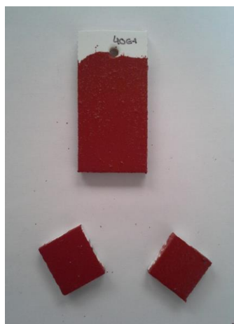
Figura 3.8 – Exemplo de placas de PVC revestidas com tinta de base poliuretano, contendo microcápsulas 40E1, para testes de lixiviação (6x3cm) e testes microbiológicos (2x2cm).
