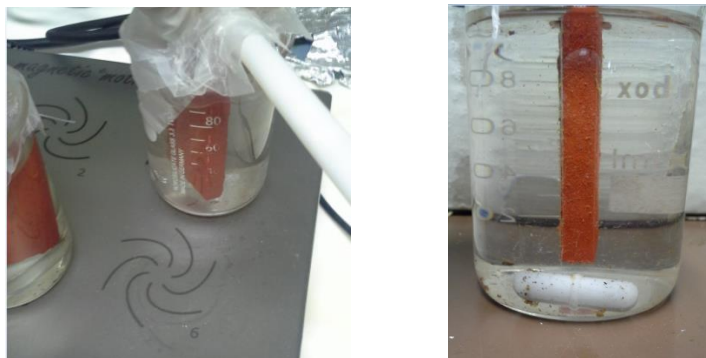
Figura 3.9- Testes de lixiviação das placas de PVC (6x3cm) revestidas com tinta marítima de base poliuretano, contendo microcápsulas biocidas.
