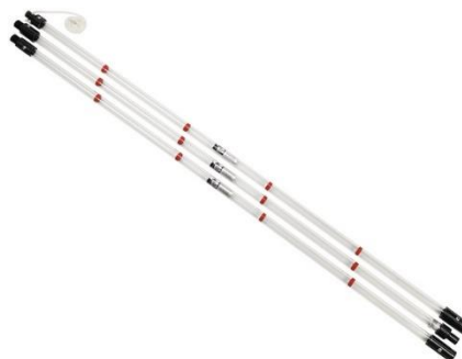
Figura 40 – Amostrador de lamas por secções, Sludge Judge (Hach, 2015).
