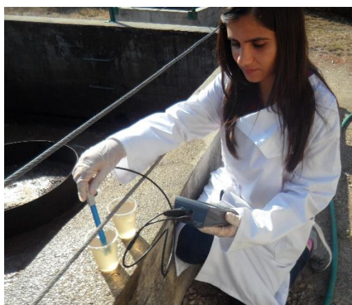
Figura 4 – Determinação da temperatura e pH numa amostra do efluente do decantador secundário.
