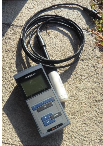
Figura 50 – Medidor portátil de oxigénio dissolvido, impermeável e com sonda.
