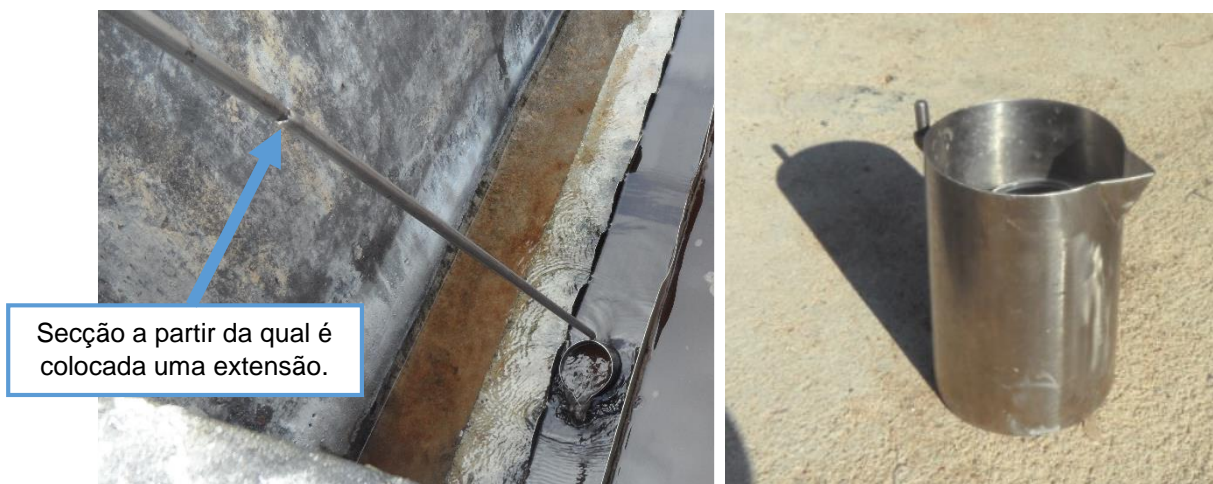
Figura 42 – Colhedor de amostras (direita: colheita de amostra de um decantador secundário da ETAR da Área de Serviço da BP da Mealhada; esquerda: pormenor do colhedor de amostras utilizado).
