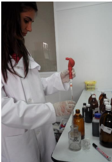
Figura 5 – Acidificação da amostra destinada à determinação da concentração de fósforo.
