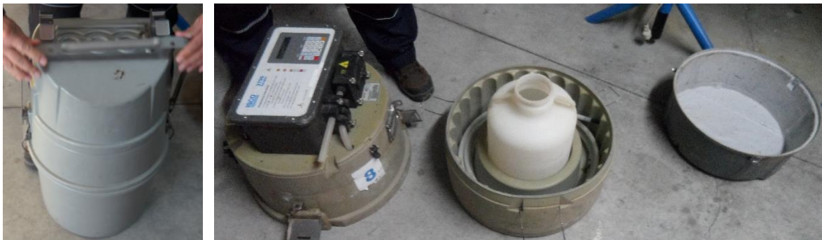
Figura 1 – Amostrador automático para recolha de amostras compostas (esquerda: equipamento fechado; direita: equipamento aberto).
