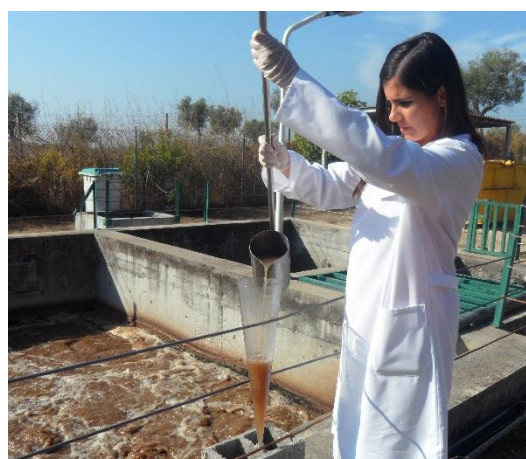
Figura 3 – Teste de sedimentação do cone Imhoff das lamas do tanque de arejamento.
