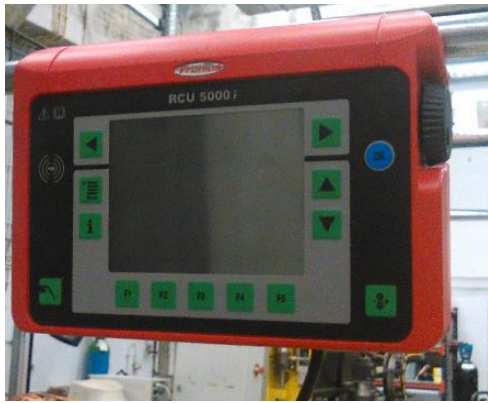
Figure 3.3: Fronius parameter controller RCU 5000i
