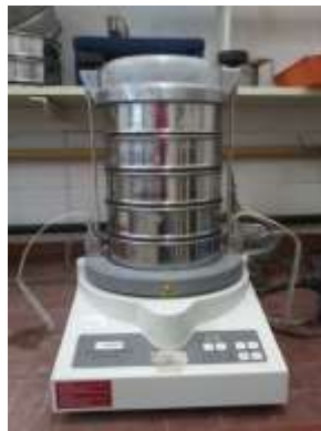
Figura 16 – Agitador vibratório ( Fritsch Analysette ) utilizado no trabalho experimental; demonstração da montagem dos crivos.
